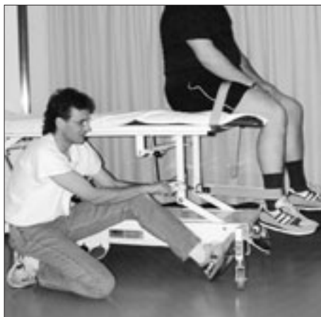
Abbildung 4: Isometrische Kraftmessung der Knieextension mit der Kraftmesszelle nach Huber et al. (Huber et al. 1997).
